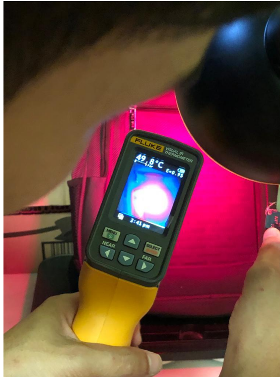
Gambar 4. 8 Pengujian Alat Terapi Infrared Dengan Alat Infrared Thermal Imaging .
