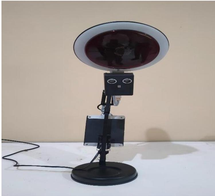
Gambar 1. Rancangan alat terapi infra merah dengan kontrol suhu (SIMOKS)
